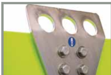
3-х позиционная скоба для подъема краном обеспечивает равновесное положение при различных объемах заправки
