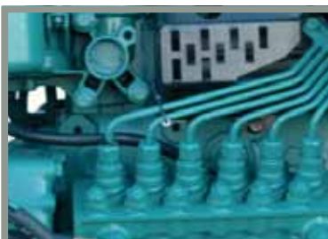
Шестицилиндровый двигатель, обладающий хорошей балансировкой
