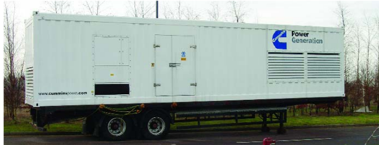
Дизель-генераторная установка Cummins C2200 D5E в 40-футовом мобильном контейнере PowerBox™ PB-40X с повышенными характеристиками шумоглушения SuperSilenced™, размещена на стандартном автоприцепе.
